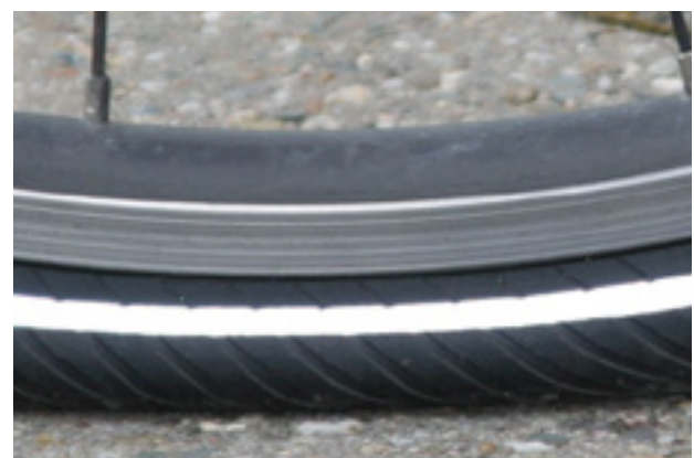
Figura 98: Presión de inflado demasiado baja
