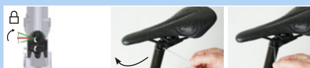
Figura 185: Cierre del ajuste de altura
