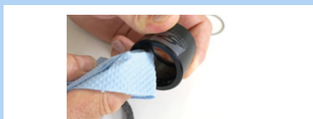
Figura 160: Limpieza del manguito exterior
