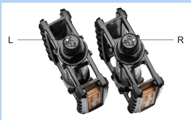
Figura 76: Ejemplo de identificación de los pedales
