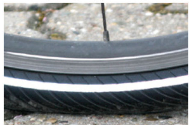
Figura 97: Presión de inflado correcta. La cubierta apenas está deformada bajo la carga del peso corporal
