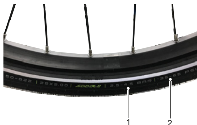
Figura 134: Presión de inflado en bar (1) y psi (2)
