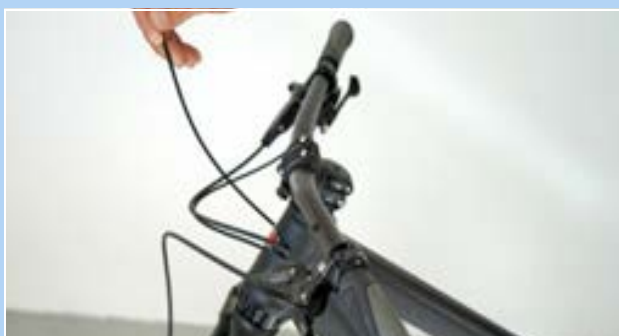
Figura 207: Enganchar la tapa del extremo
