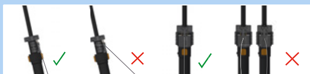
Figura 175: Cable Bowden correcto e incorrecto
