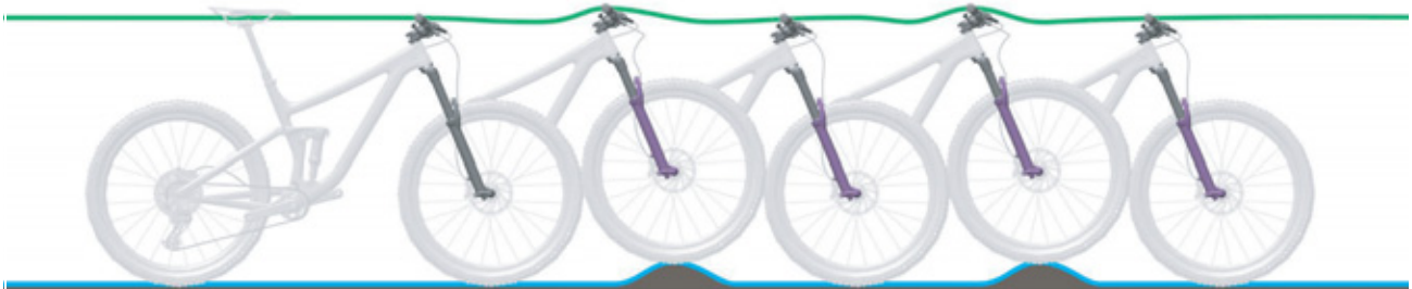
Figura 11: Condición óptima de marcha de la horquilla
