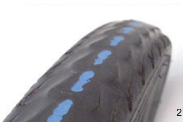
Figura 135: Cubierta sin perfil que aún puede utilizarse (1); cubierta con protección contra pinchazos visible que tiene que cambiarse (2)
