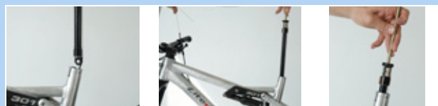
Figura 176: Fijación la tapa de la válvula del cartucho
