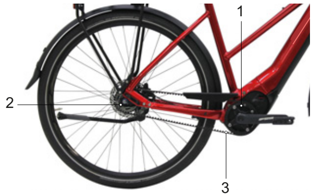
Figura 27: Esquema de la transmisión por correa
