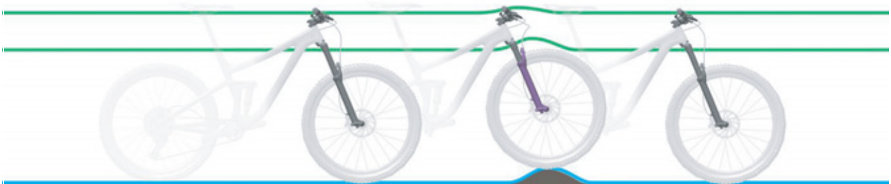
Figura 10: Condición óptima de marcha de la horquilla en caso de irregularidades
