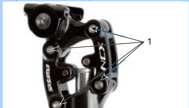
Figura 147: Puntos de lubricación de la tija de sillín de muelle SR Suntour
