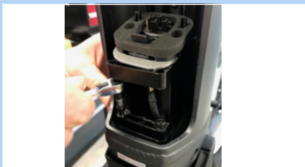
Figura 48: Retirada de los tornillos hexagonales de 4 mm
