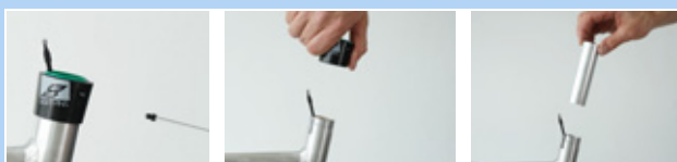
Figura 156: Desmontaje del manguito exterior y del casquillo deslizante
