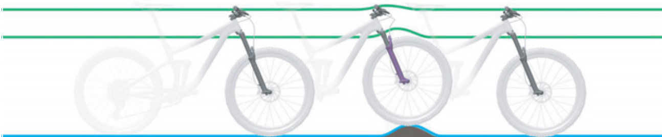
Afbeelding 10: Optimaal rijgedrag van de vork bij oneffenheden
