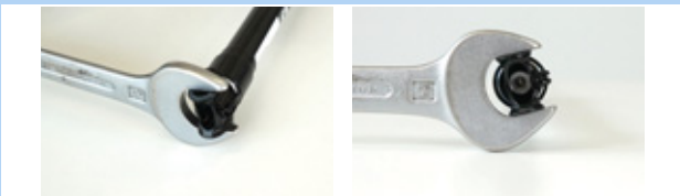
Afbeelding 151: Borgen tegen verdraaien
