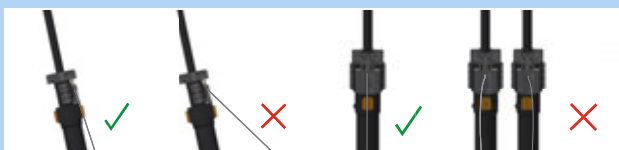
Afbeelding 157: Correcte en verkeerde bowdenkabel
