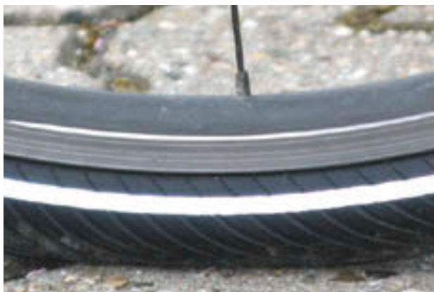
Slika 143: Ispravan tlak u gumi. Guma se jedva deformira pod tjelesnom težinom
