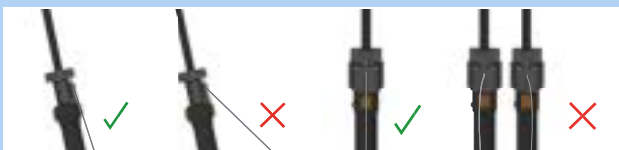
Slika 273: Ispravan i pogrešan bužir sa sajlom
