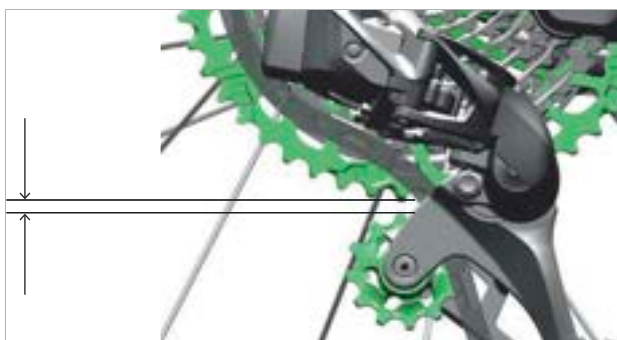
Slika 159: Razmak od 3 mm između kotačića i zubaca
