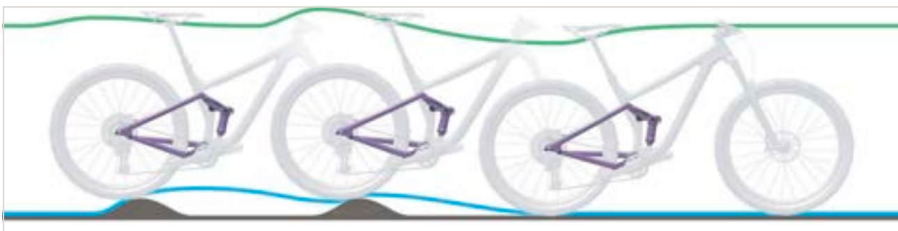
Slika 333: Presporo odskakivanje stražnjeg amortizera
