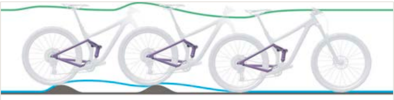
Slika 325: Presporo odskakivanje stražnjeg amortizera
