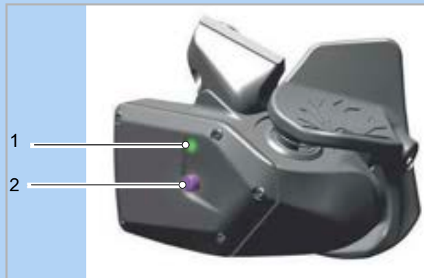
Slika 107: Ručica mjenjača SRAM AXS-Controller s LED lampicom (ručica mjenjača) (1) i tipkom AXS (ručica mjenjača) (2)
