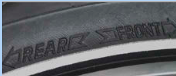
Slika 87: Strelica smjera vožnje na MTB gumama
