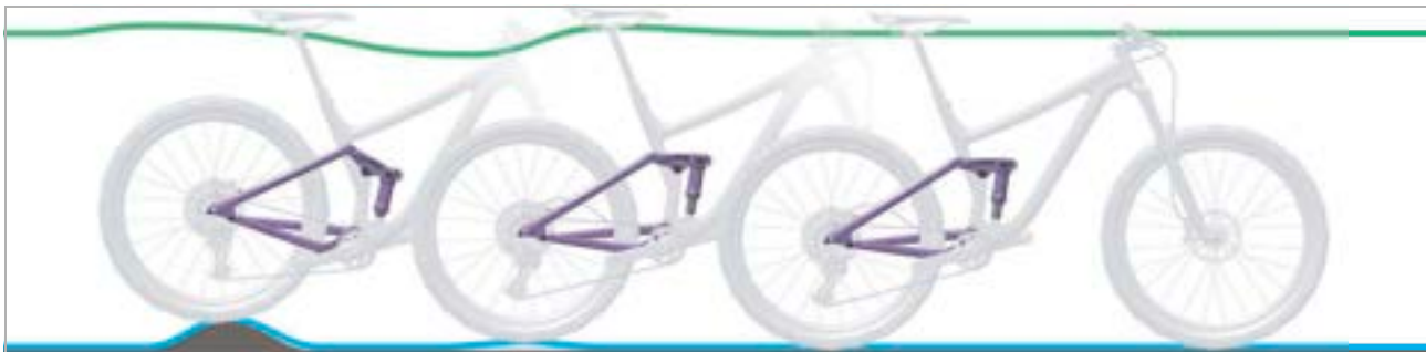
Slika 331: Prebrzo odskakivanje stražnjeg amortizera
