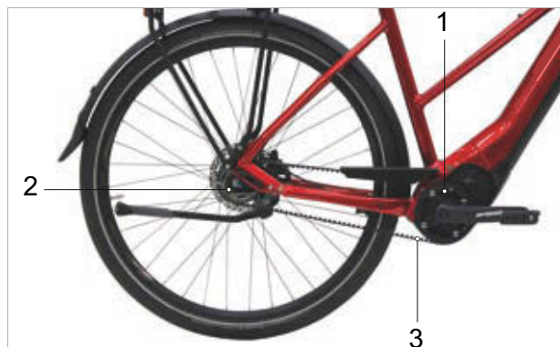
Slika 51: Shema remenskog pogona
