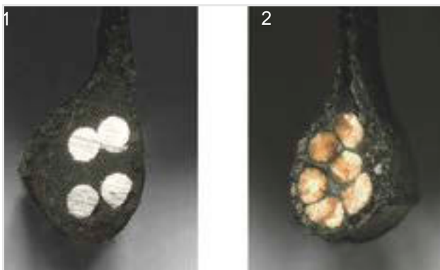
Slika 31: Čelična jezgra (1) i jezgra s Kevlar nitima (2)
