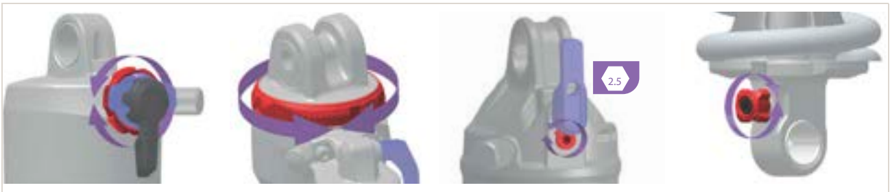
Slika 324: Položaj i oblik kotačića za podešavanje odskoka (na stražnjem amortizeru) (crveni) ovisi o modelu
