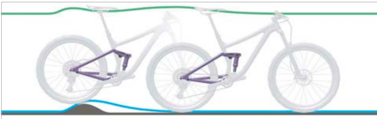
Slika 337: Prekruta amortizacija stražnjeg amortizera na neravninama
