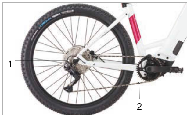
Slika 50: Shema lančanog pogona s mjenjačem
