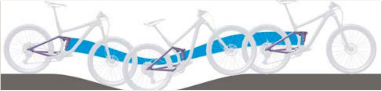
Slika 327: Premekan ovjes stražnjeg amortizera na uzbrdici
