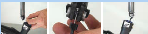
Slika 304: Postavljanje i uvođenje cijevi sjedala
