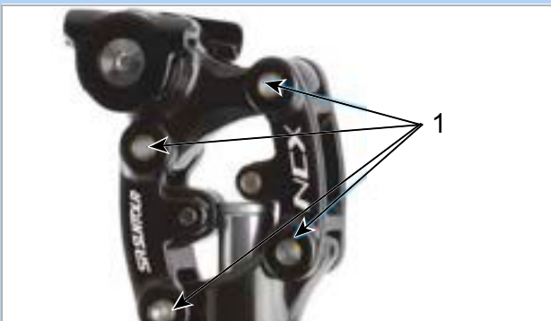
Slika 245: Točke podmazivanja amortizacijske cijevi sjedala SR SUNTOUR
