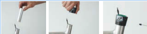
Slika 303: Ugradnja klizne i vanjske čahure
