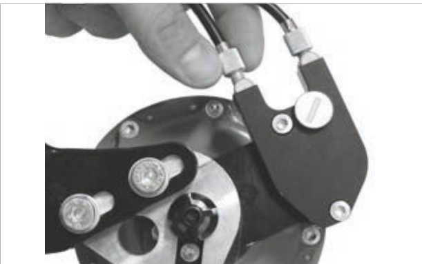
Slika 240: Kod verzija ROHLOFF glavčina s vanjskim upravljanjem brzinama, kotačići za podešavanje zategnutosti nalaze se na kutiji za sajlu koja se nalazi na lijevoj strani
