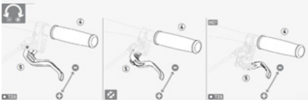
Figura 68: Ajustar el ancho de agarre de la palanca de freno con freno de disco Magura
