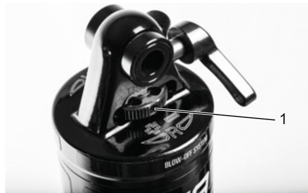
Figura 74: Rueda del regulador de niveles de tracción Suntour (1) en el amortiguador de la horquilla trasera
