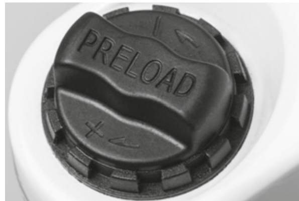
Figura 70: Rueda de ajuste del recorrido negativo de muelle en la corona de la horquilla de suspensión
