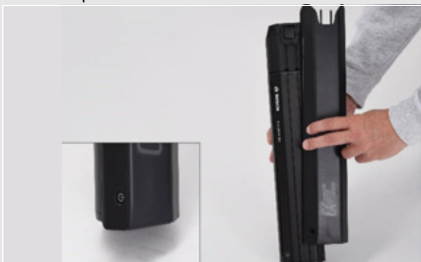
Figura 38: Desplazamiento de la cubierta de la batería sobre la batería
