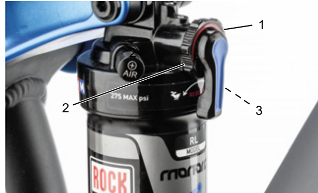
Figura 88: Ajuste de la dureza del amortiguador de niveles de tracción en la rueda de ajuste (1) del amortiguador de la horquilla trasera
