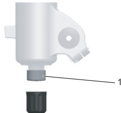
Figura 73: Regulador de niveles de tracción FOX (1) en la puntera de la horquilla
