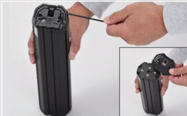
Figura 35: Desmontaje de la interfaz superior
