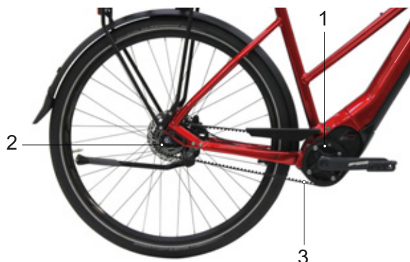
Obr. 35: Schéma řemenového pohonu
