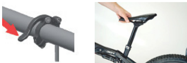
Obr. 94: Vysunutí hydraulické plynové tlačné pružiny
