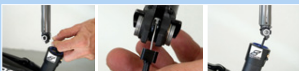
Obr. 250: Zavedení a zasunutí sedlovky
