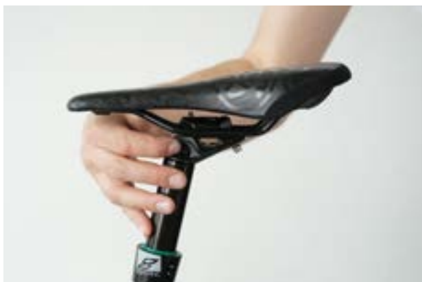
Obr. 102: Nastavení sklonu sedla na nastavovacím kolečku
