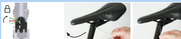
Obr. 229: Zavření nastavení výšky
