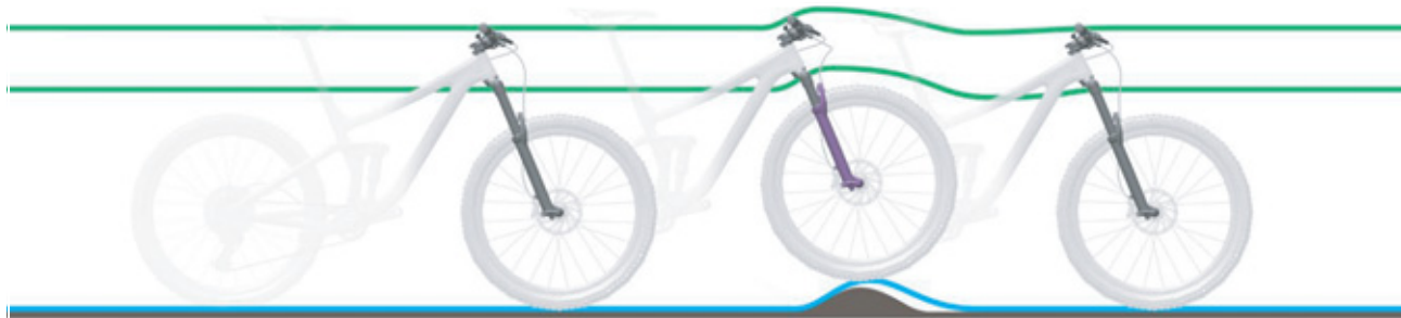
Obr. 260: Příliš tvrdé tlumení odpružené vidlice u nerovnosti
