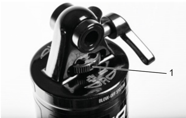
Obr. 273: Nastavovací šroub odskoku Suntour (1) na tlumiči zadního odpružení
