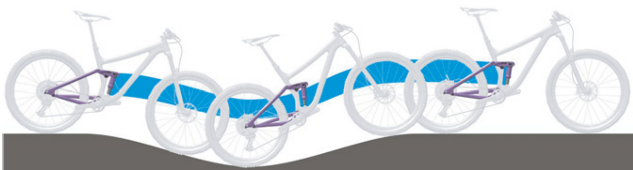
Obr. 22: Optimální chování tlumiče zadního odpružení při jízdě v kopcovitém terénu
