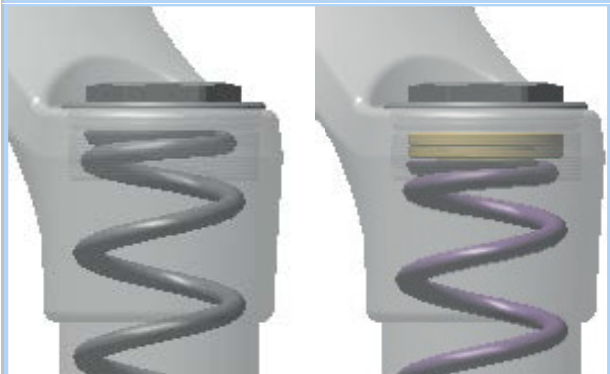
Obr. 137: Otáčení nastavovacím kroužkem předpětí dovnitř a ven
