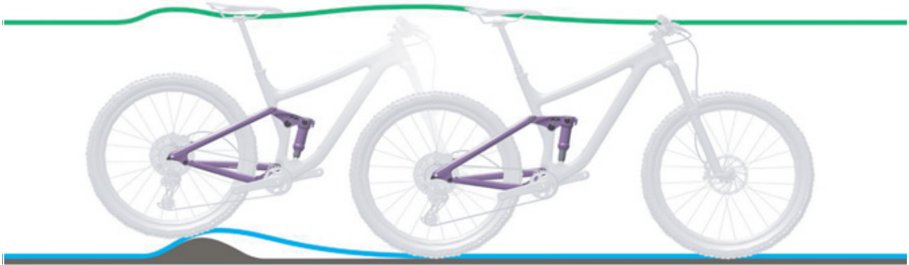
Obr. 284: Příliš tvrdé tlumení tlumiče zadního odpružení u nerovnosti
