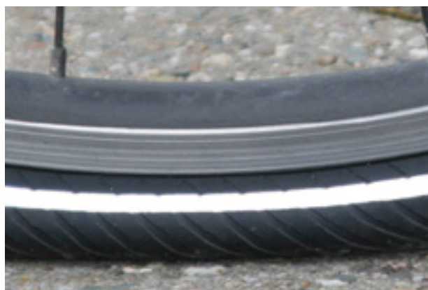
Obr. 117: Příliš nízký tlak
