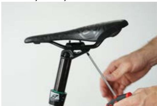
Obr. 105: Povolení zadního šroubu
