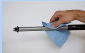
Obr. 245: Očištění podélné vodicí drážky
