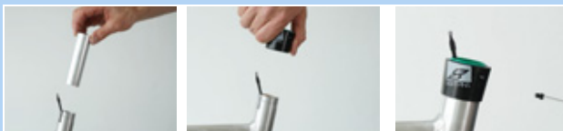
Obr. 249: Montáž kluzného pouzdra a vnějšího pouzdra
