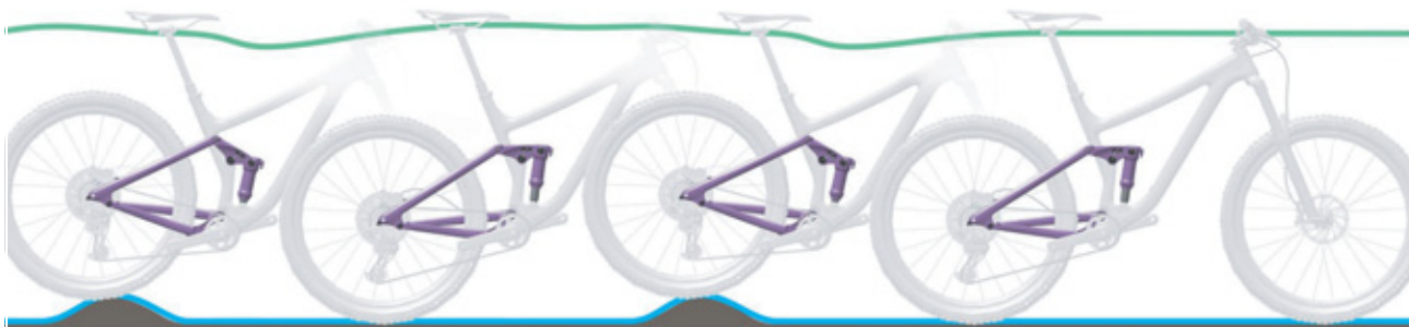
Obr. 21: Optimální chování tlumiče zadního odpružení při jízdě
