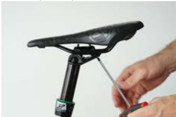
Obr. 101: Povolení zadního šroubu
