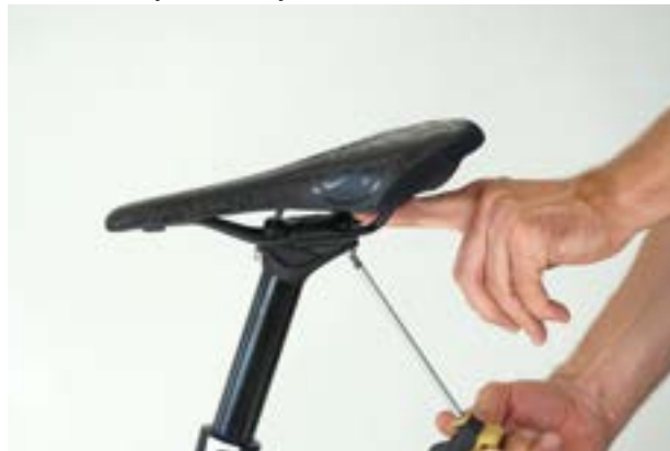
Obr. 99: Povolení zadního šroubu
