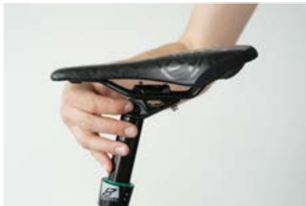
Obr. 106: Nastavení sklonu sedla na nastavovacím kolečku
