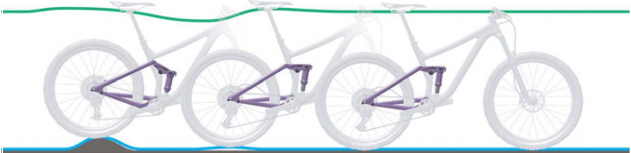
Obr. 278: Příliš rychlé roztahování tlumiče zadního odpružení
