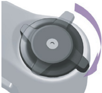
Obr. 171: Tvrdé nastavení nastavovacího šroubu komprese
