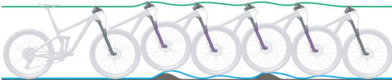
Obr. 254: Příliš rychlé roztahování odpružené vidlice
