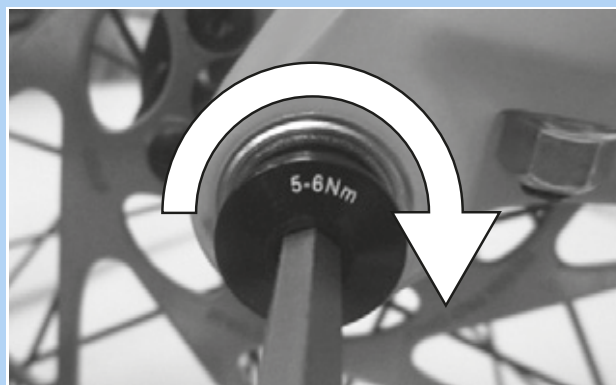
Obr. 73: Utažení pojistného šroubu
