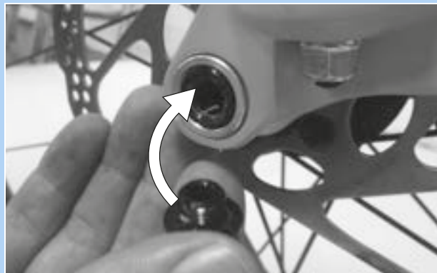
Obr. 72: Zasunutí páky rychloupínáku do osy
