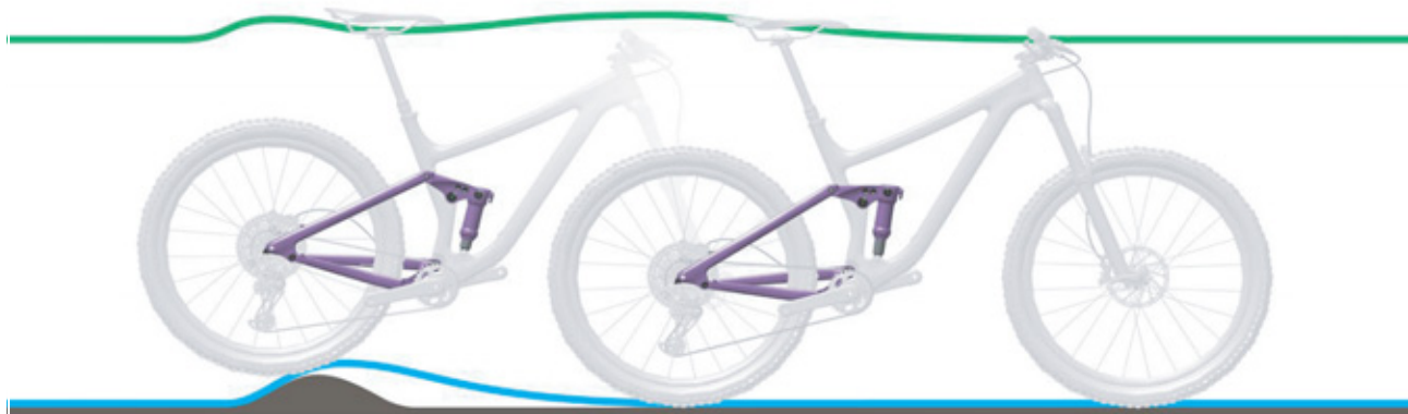
Obr. 276: Příliš tvrdé tlumení tlumiče zadního odpružení u nerovnosti
