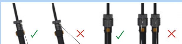
Obr. 219: Správné a nesprávné vedení bovdenů
