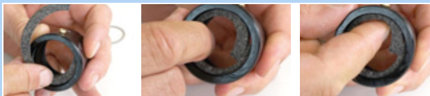
Obr. 205: Vložení plstěného kroužku
