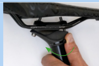
Obr. 248: Zavření nastavení výšky
