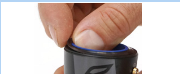
Obr. 235: Demontáž kroužek s těsnicími bříty
