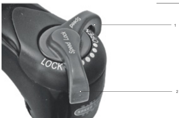
Obr. 261: Měkké nastavení nastavovacího šroubu komprese
