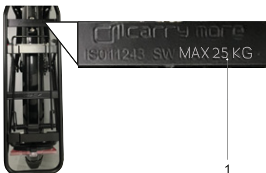
Obr. 159: Na nosiči zavazadel je uvedena jeho maximální nosnost (1)
