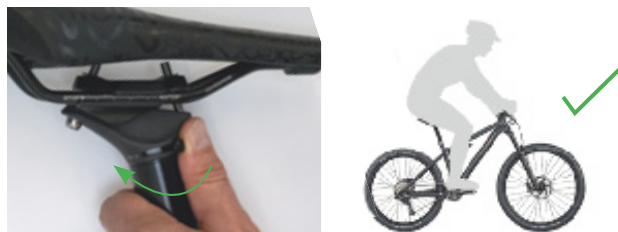
Obr. 96: Utažení osy sedlovky
