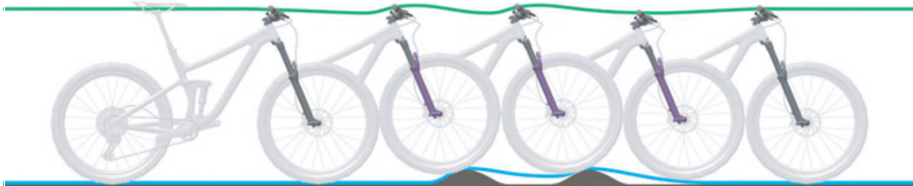
Obr. 264: Příliš pomalé roztahování odpružené vidlice
