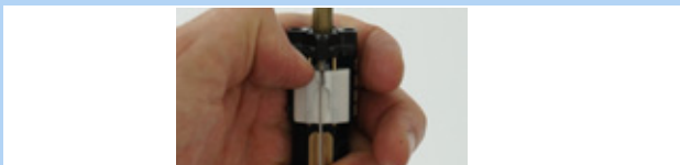
Obr. 218: Posunutí bílého ovládacího šoupátka dolů
