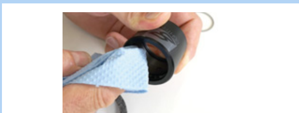
Obr. 204: Čištění vnějšího pouzdra
