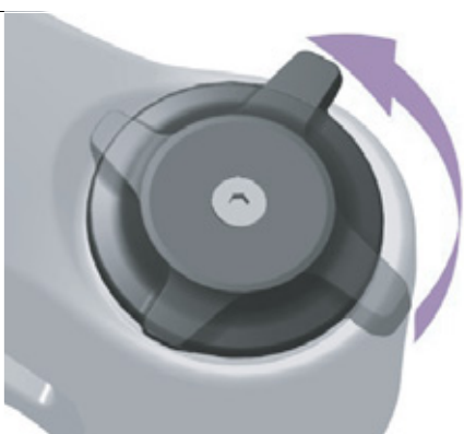
Obr. 269: Měkké nastavení nastavovacího šroubu komprese
