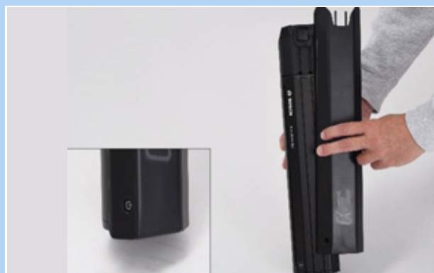
Obr. 67: Nasunutí krytu na akumulátor
