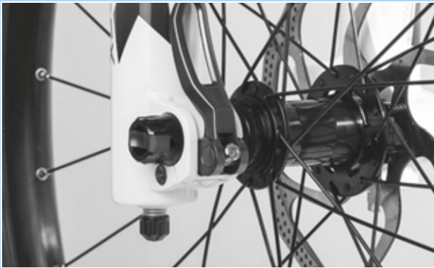
Afbeelding 142: Spankracht van de snelspanner afstellen
