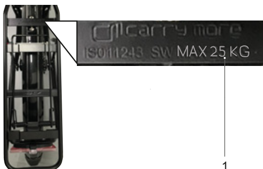
Afbeelding 112: Op de bagagedrager staat het maximale draagvermogen (1) vermeld
