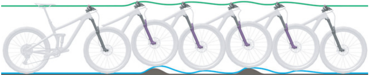
Afbeelding 215: Te snel uitveren van de verende voorvork
