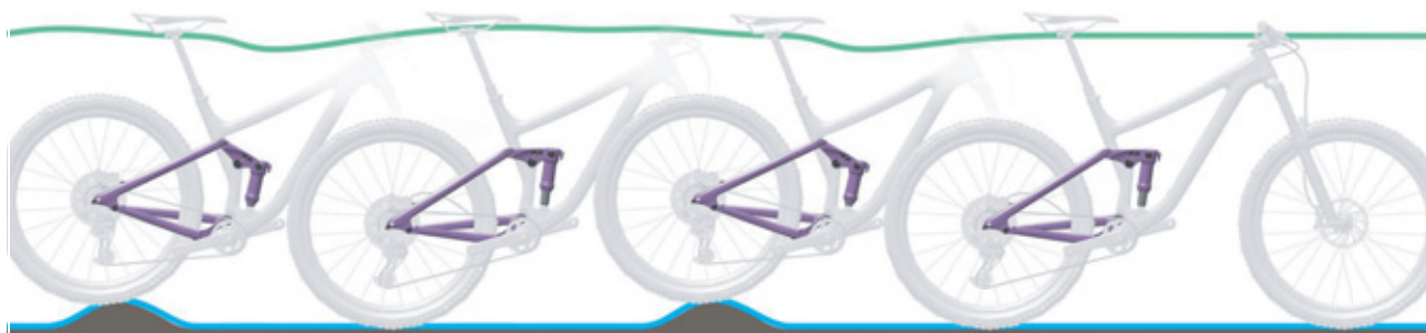
Afbeelding 95: Optimaal rijgedrag van de achterbouwdeemper
