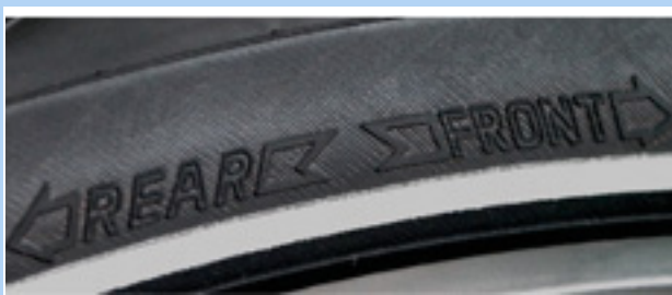
Afbeelding 60: Pijl draairichting op MTB-banden
