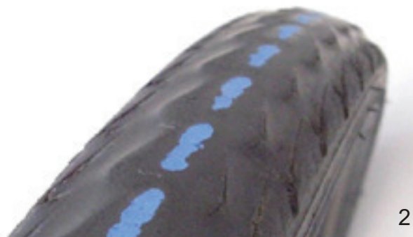
Afbeelding 132: Een band zonder profiel waarmee nog kan worden gereden (1), en een band met zichtbare anti-leklaag (2), die moet worden vervangen
