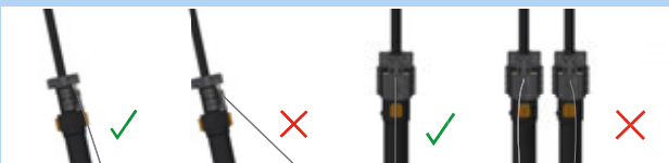
Afbeelding 172: Correcte en verkeerde bowdenkabel
